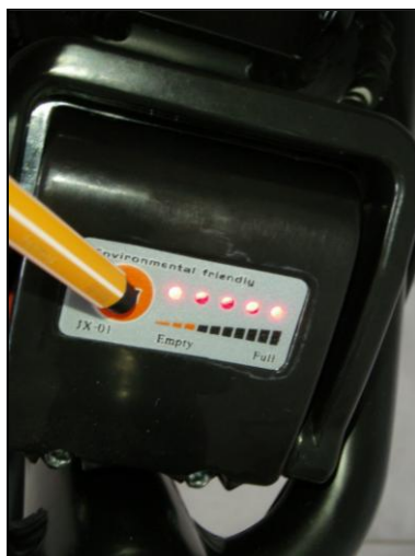
kontrola stavu nabití baterie
